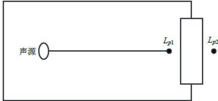
图 4.2-2 室内声源等效为室外声源图例
