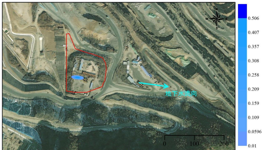
图 6.3-1 非正常工况下调节池泄露 100d 氟化物地下水影响范围图
