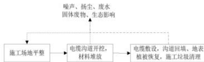
图5 电缆工程施工工艺流程图
