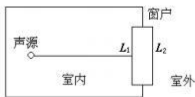
图 5.2-4 室内声源向室外传播示意图
