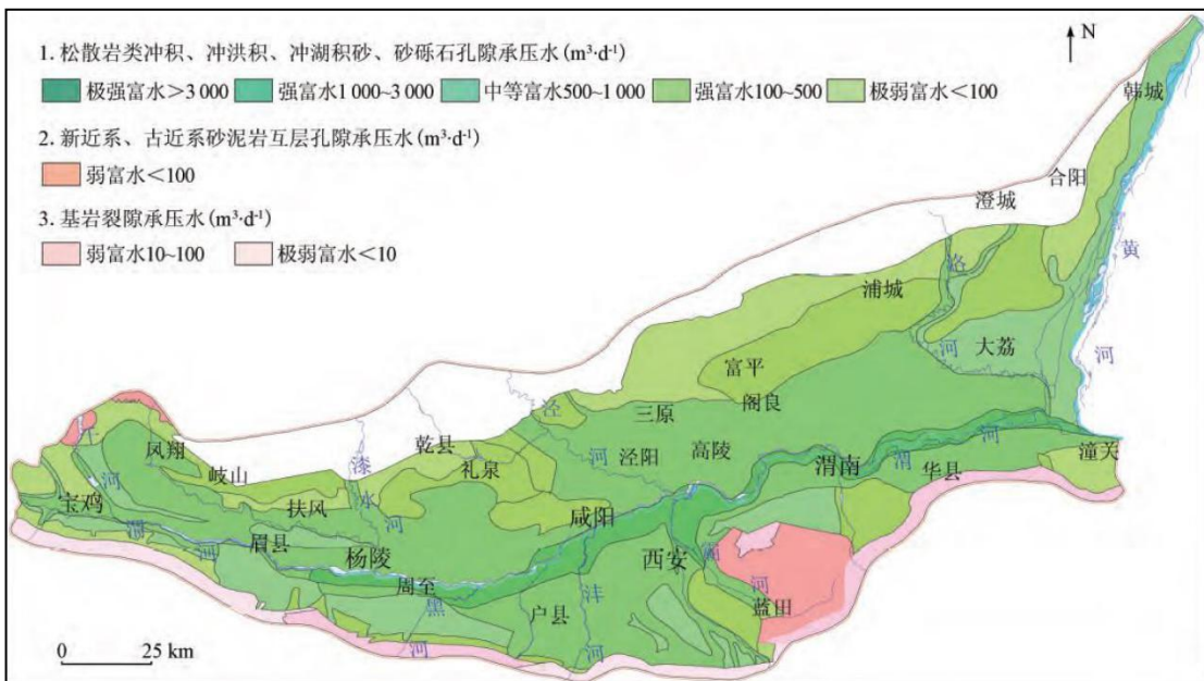
图 5.2-2 关中盆地承压水水文地质图
