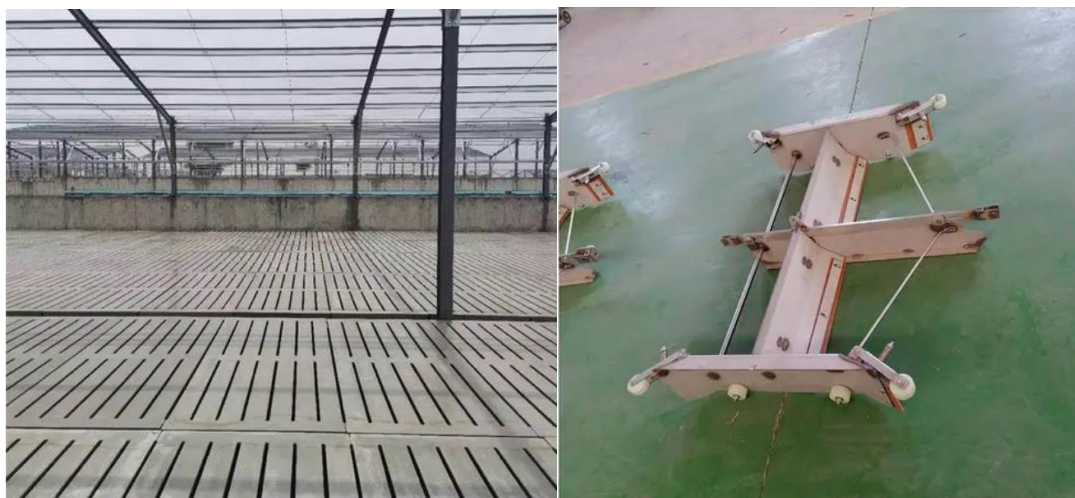
图 2.3-3 漏粪板及刮粪板示意图
